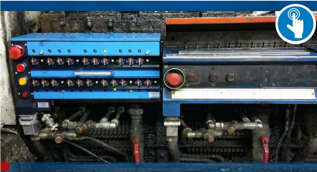
Während der Glasstec 2016, stellt MAC Valves sein exklusives Design des 21-Spuren Ventilblockes aus. Die letzte Version vom 21-Spuren Ventilblock wird in mehreren Konfigurationen ausgestellt, die sich je nach Ihrer Maschine anpassen.
