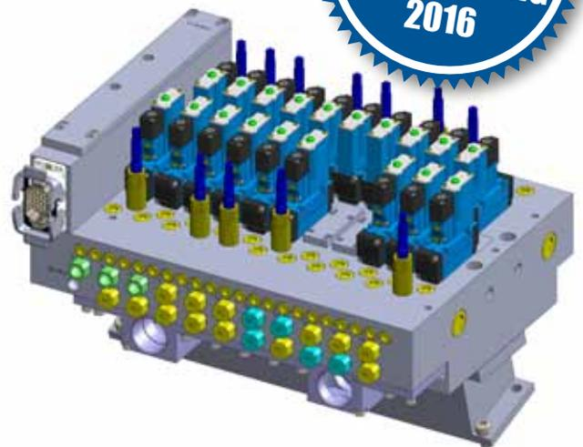
MAC Valves 21-Spuren Ventilblock mit Optionen wie z.B. verschobene Ausrichtung, integrierte Durchflussregler, dual-Inlet, 21 individuelle Luftversorgungen
