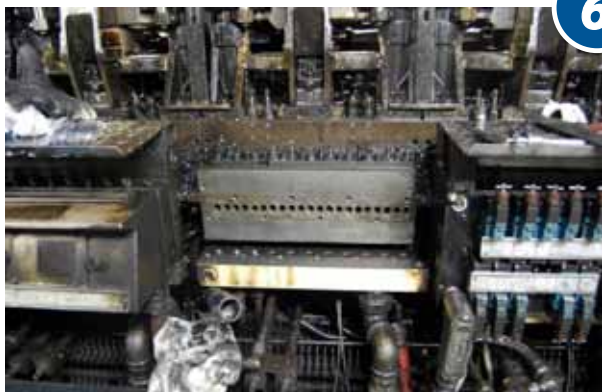
OTER LE BLOC A CARTOUCHES DE LA PLAQUE DE REGULATION DE DEBIT + DU COLLECTEUR D'AIR
