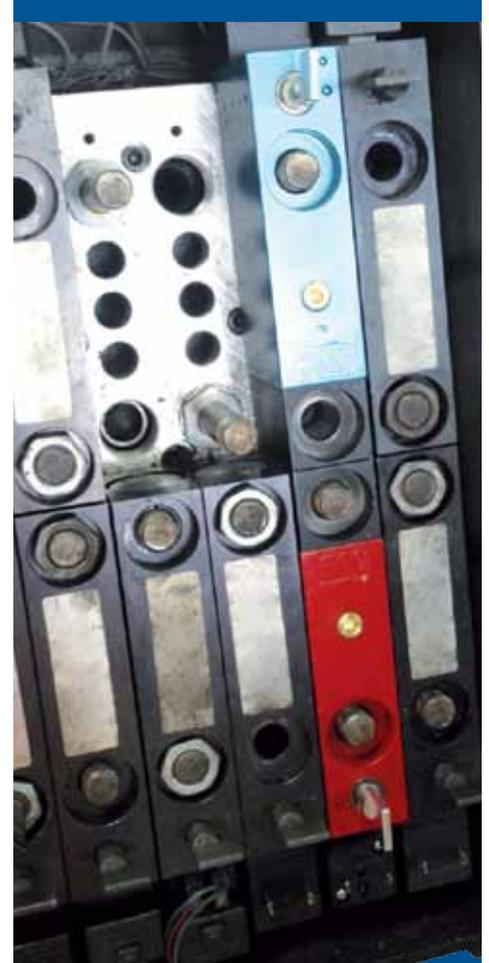
MAC Valves stellt eine 100% passgenaue Alternativlösung vor um die Ventile auf dem 26-Spuren Ventilblock 1:1 auszutauschen. Besondere Eigenschaften des MAC Ventils sind z.B. die Verwendung der bewährten Schieberkolbentechnologie, und die Vorsteuerung mittels Bullet Valve™ Piloten.
