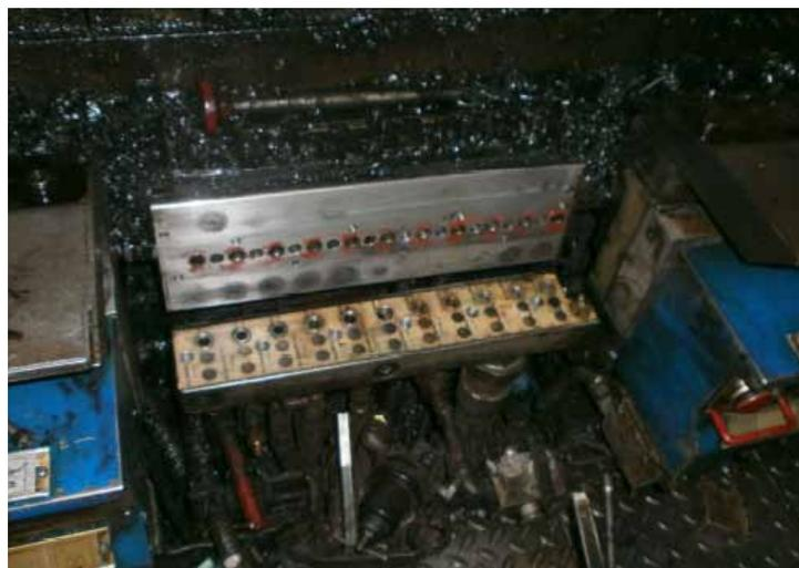
Montageplatte maschinenseitig (Kissplate), an der der Block montiert wird
