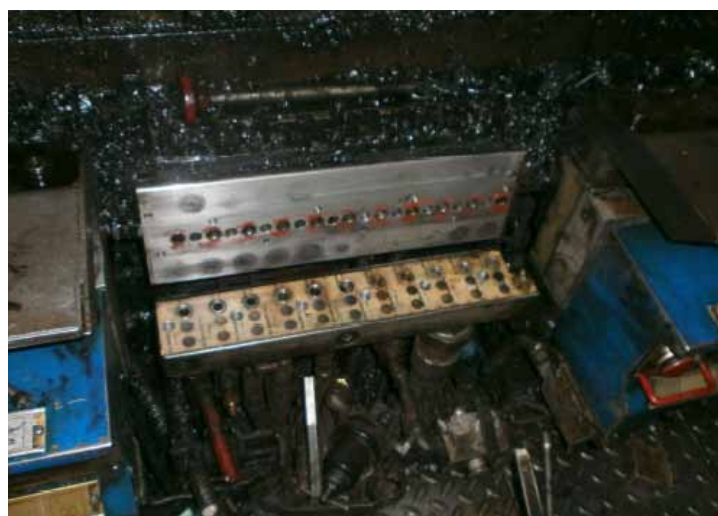
'Kissplate' sur laquelle est monté le bloc
