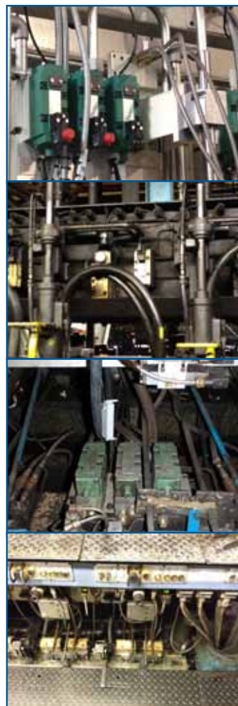
Beispiele für ISO-Ventile des Wettbewerbs in IS-Glasmaschinen
